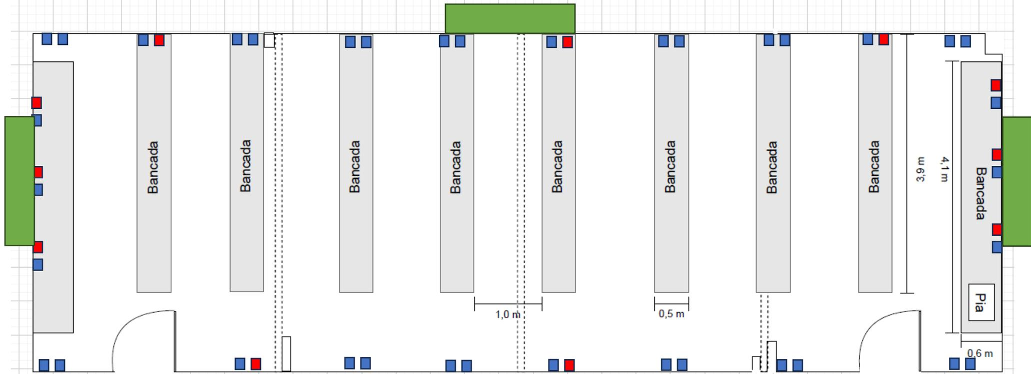
Previsão de instalação elétrica para Ar-condicionado split 220V
